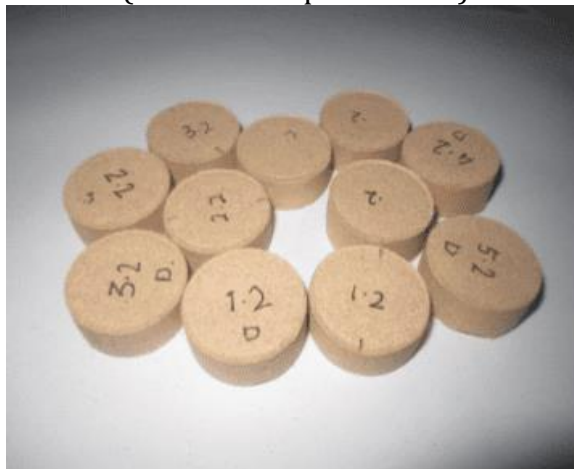
Gambar 3. 14. Briket dengan suhu pencetakan 120 derajat celcius (Naim and Saputro 2013)
