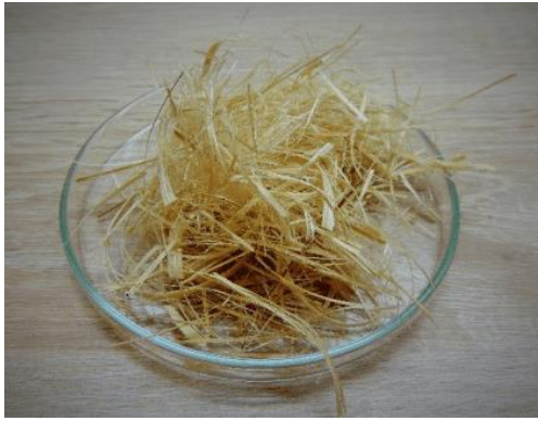
Gambar 3. 101. Bentuk sampel yang disiapkan untuk analisis kimia dan mekanik serat bambu(Brunerová et al. 2018).
