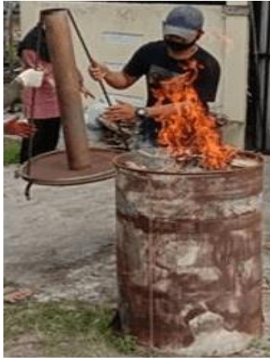
Gambar 3. 30. Proses pembakaran limbah kayu Sengon menjadi arang
