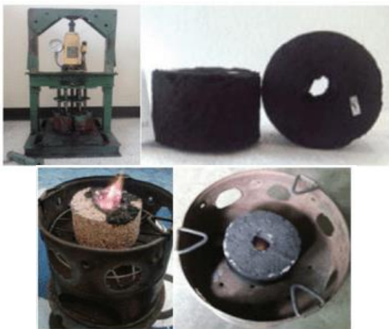
Gambar 4. 9. Proses Pengepresan briket dengan tangan untuk menghasilkan briket , warna api briket mula-mula merah berubah menjadi biru.
