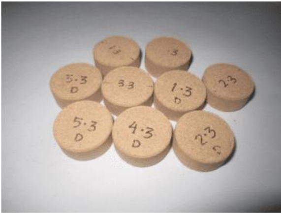
Gambar 3. 15. Briket dengan suhu pencetakan 140 derajat Celcius (Naim and Saputro 2013)
