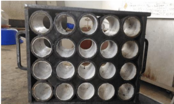
Gambar 3. 7. Alat cetak briket campuran arang kayu Sengon dan arang kayu Ulin(Rindayatno and Lewar 2017)
