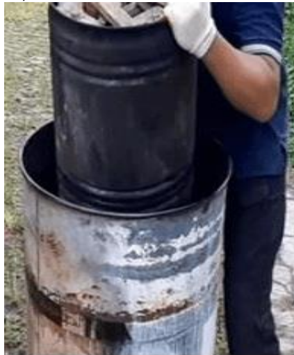
Gambar 3. 29. Bentuk alat pembuatan arang briket kayu Sengon yang terbuat dari Drum
