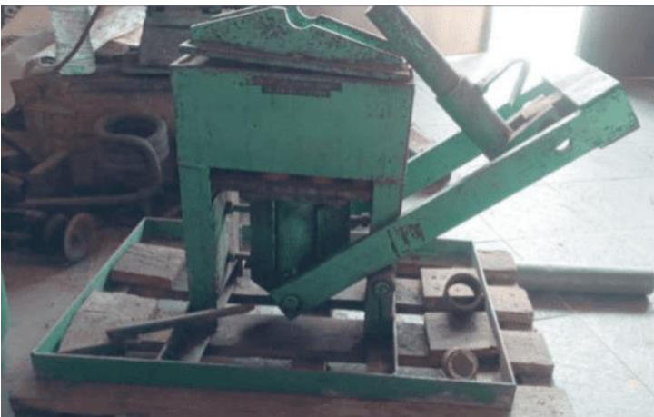
Gambar 3.42 Alat hidrolik pencetak briket kayu Karet
