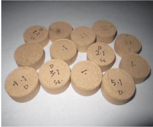
Gambar 3. 13. Briket dengan suhu pencetakan 100 derajat Celsius (Naim and Saputro 2013)
