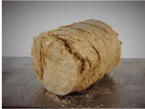
Gambar 3. 108. Sampel bahan bakar biobriket setelah pengujian Gaya pecah serat bambu(Brunerová et al. 2018).
