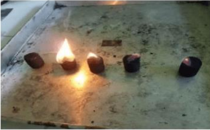
Gambar 4. 12. Pengujian Laju Pembakaran pada Biobriket (Pramana and Nanik 2022).
