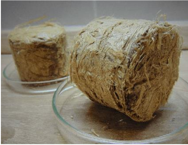
Gambar 3. 107. Sampel bahan bakar biobriket serat bambu setelah pengujian daya tahan mekanik(Brunerová et al. 2018).
