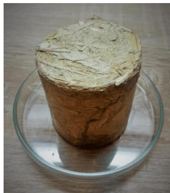
Gambar 3. 104. Sampel bahan bakar biobriket yang dihasilkan dari serat bamboo(Brunerová et al. 2018).
