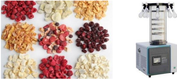
Gambar 4. 5. a) Produk buah-buahan hasil freeze drying (Habibi et al. , 2019); b) Mesin freeze dryer (Labfreez, 2024)
