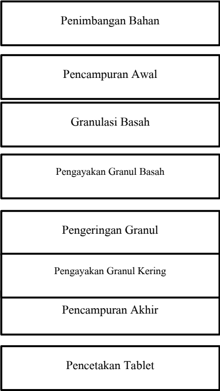
Gambar 5. 1. Tahapan Metode Granulasi Basah
