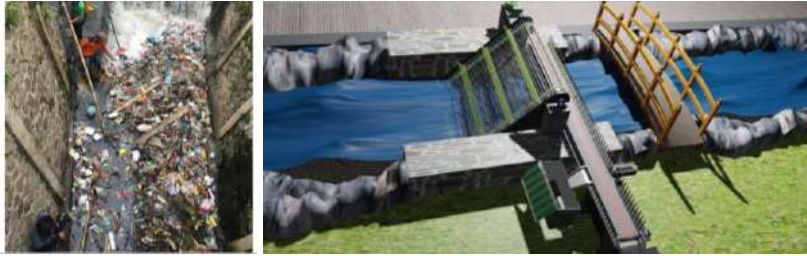
Gambar 7.3. Sistem pengangkutan sampah otomatis Sumber : Rustandi et al., 2021
