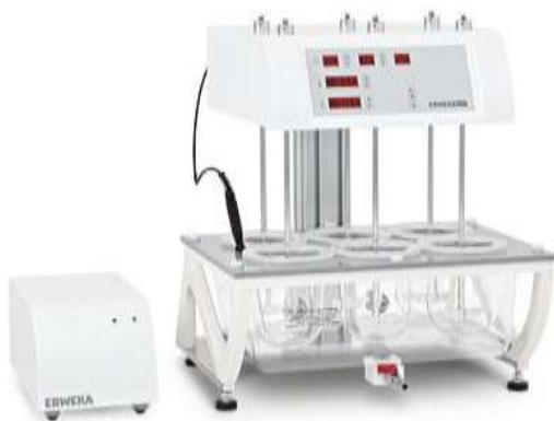
Gambar 13.1. Alat Uji Disolusi Tablet (Erweka) (Sumber: ( website , 2023))
