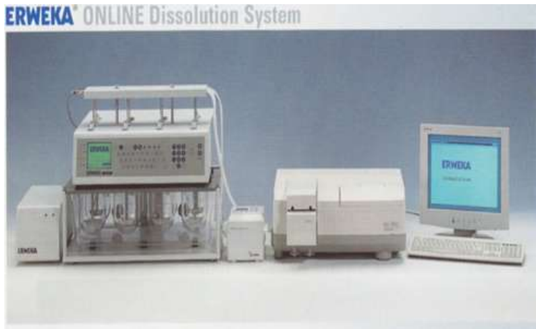
Gambar 11.5. Alat uji disolusi tablet (Erweka DT 708) Sumber : (Syukri, 2018)
