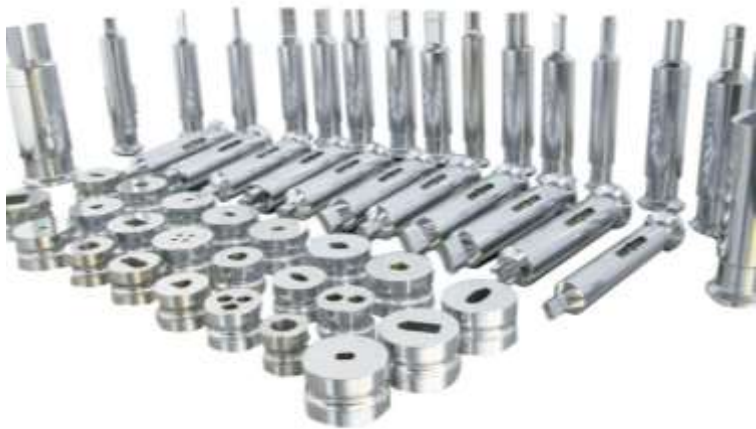
Gambar 7.2. Berbagai jenis dan ukuran punch dan die (Sumber : https://www.shamdew.com/dies-punches/ )
