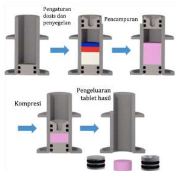
Gambar 7.11. Alur kompresi tablet single-press (Sumber : Kottlan et al. , 2023)
