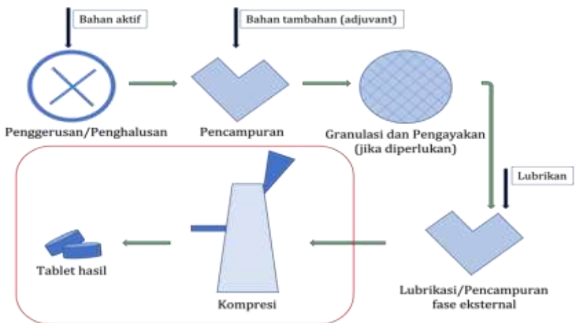
Gambar 7.1. Skema manufaktur tablet
