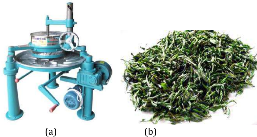
Gambar 4.9. a). Mesin Penggulung Teh, b). Daun Teh Gulung
