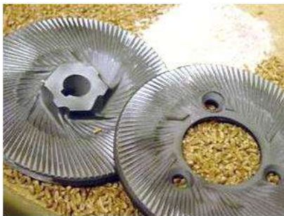
Gambar 4.7. Hammer mill pembuatan tepung Gambar 4.8. Double disc grinding (Plat gerinda)
