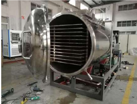
Gambar 14.16. Pengeringan Beku Bentuk silinder bentuk Batch.
