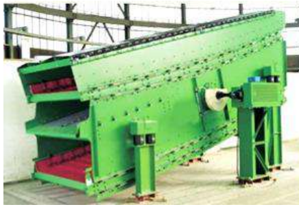
Gambar 7.7. Ayakan bergoyang dengan 3 tingkat dan menghasilkan 3 fraksi ukuran
