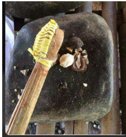
Gambar 5.10. Alat pemukul biji kemiri dengan gagang rotan yang elastis.
