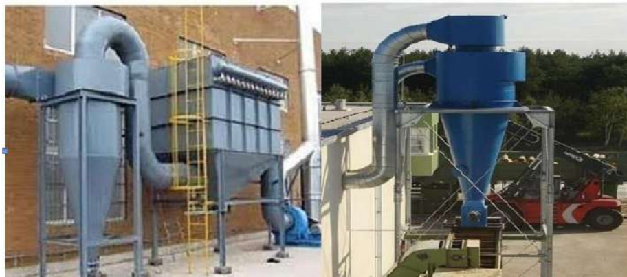
Gambar 8.1. (a). Siklon tangensial (b). Siklon aksial
