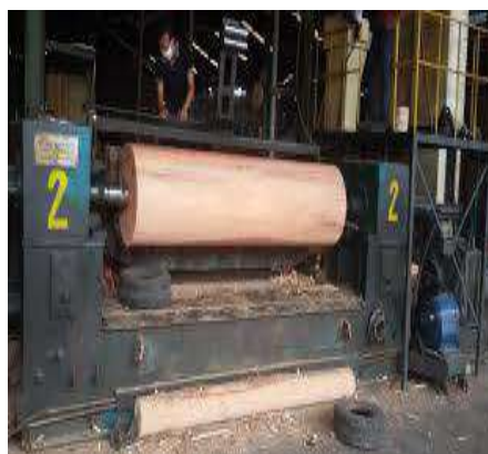
Gambar 5.15. Pembuatan lembaran lapisan tipis ( plywood ) dengan blade
