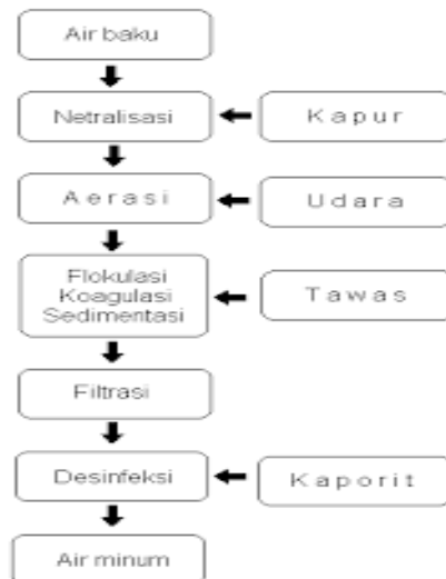
Gambar 4.12. Proses pengolahan air gambut
