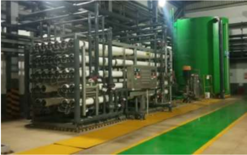
Gambar 7.4. Reverse Osmosis pada unit pengolahan air (Sumber : dokumentasi pribadi)
