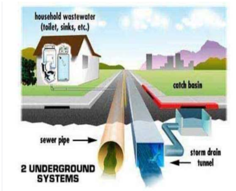
Gambar 10.3. Sistem penyaluran limbah terpisah
