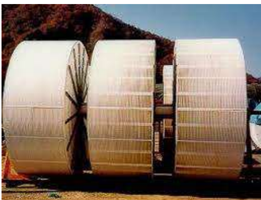
Gambar 7.7. Piringan biofilm pada reaktor biologis putar (Sumber : (Said, 2005))
