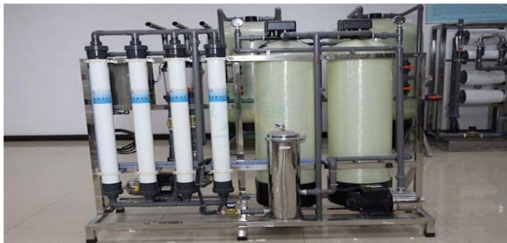
Gambar 2.25 Contoh Aplikasi Teknologi Membran Dalam Pengolahan Air
