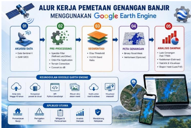
Gambar 5. 4 Alur Kerja Pemetaan Genangan Banjir Menggunakan Google Earth Engine
