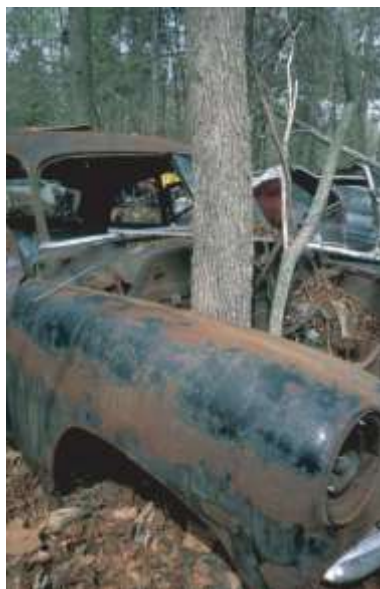
Gambar 3.1. Proses korosi melibatkan reaksi oksidasi-reduksi di mana besi logam diubah menjadi \text{Fe}(\text{OH})_3 , padatan berwarna coklat kemerahan.
