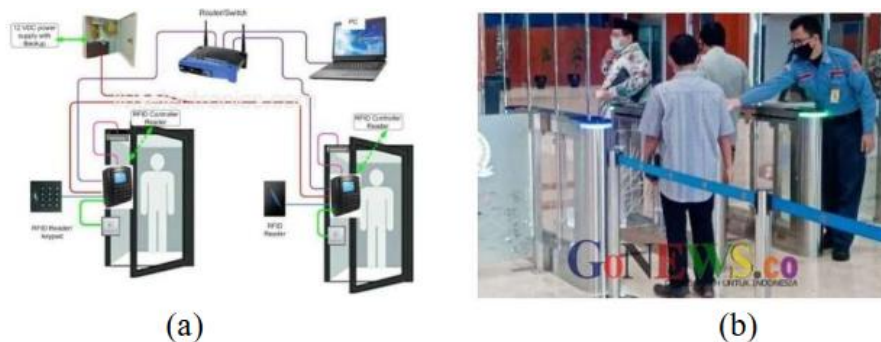
Gambar 5.14. Contoh Aplikasi pada Bangunan (a) Cara kerja sistem pengendalian akses, (b) Penerapan sistem pengendalian akses di gedung DPR RI (Sumber: Handri, Taquiuddin and Huda, 2021)
