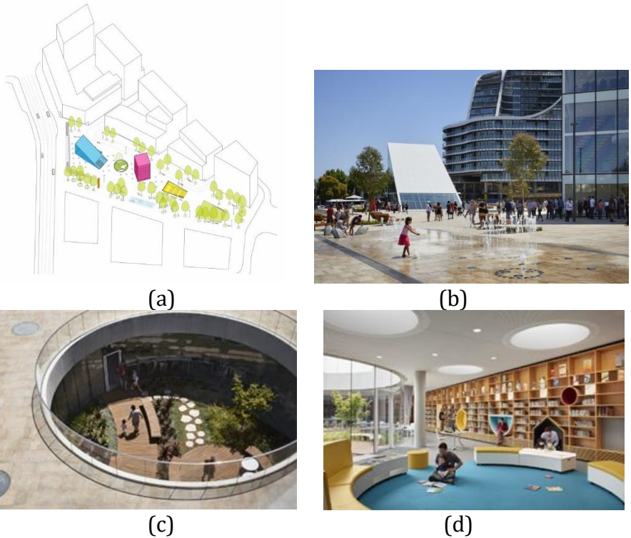
Gambar 6.5. Green Square Library, Sydney. (a) Site plan; (b) Ruang terbuka berupa plaza; (c) taman melingkar untuk menghadirkan cahaya pada ruang perpustakaan bawah tanah; (d) interior ruang baca dengan pencahayaan alami. (Sumber : Andrew Mackenzie, 2018)
